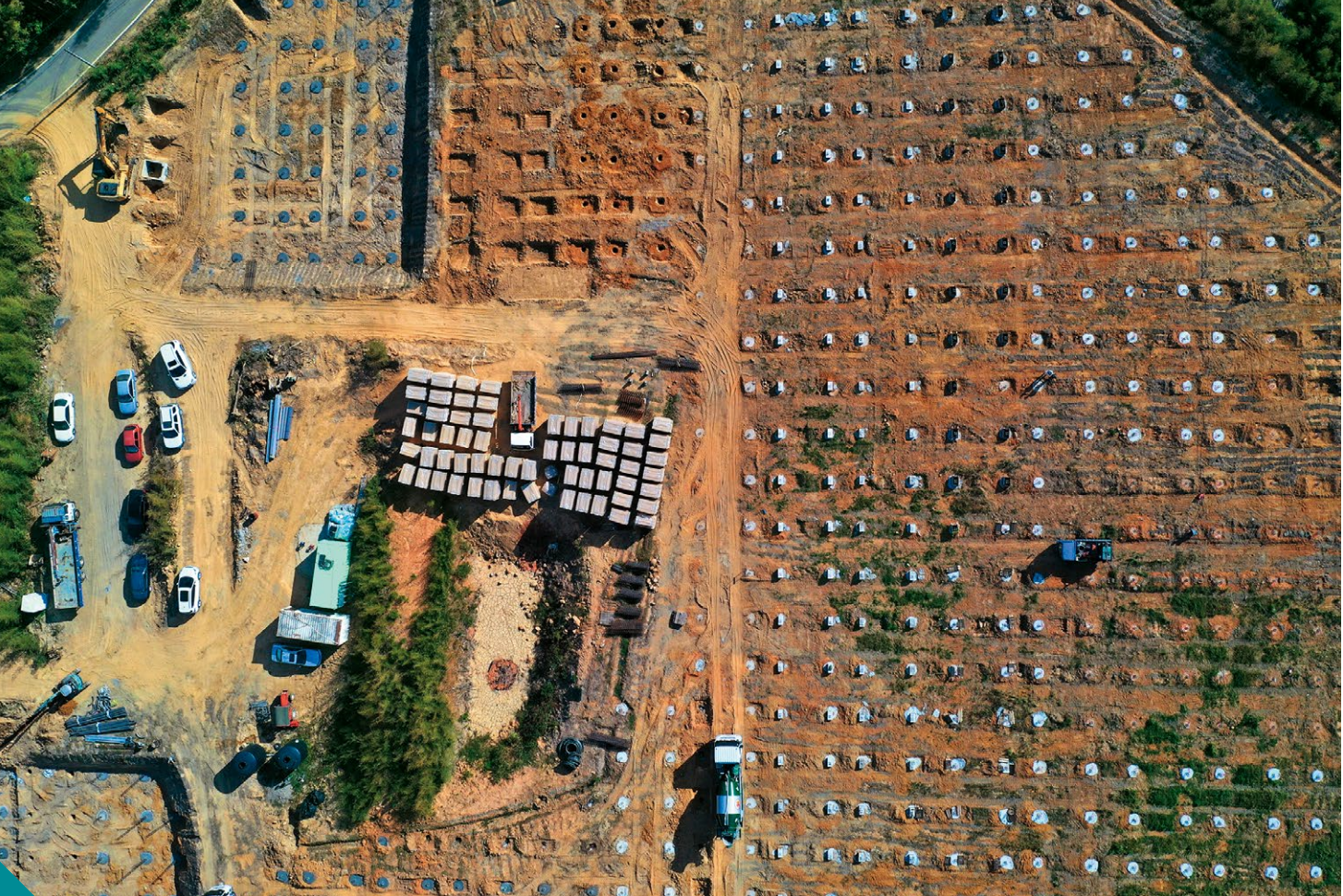
一年內，綠地變黃土。已通過苗栗縣府核准的19案光電場之一，正如火如荼趕工中，西湖山坡上打滿金屬樁。
